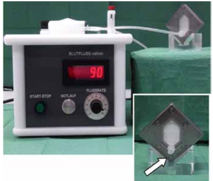
Abb. 1: Versuchsaufbau einer Flusskammer zur Untersuchung der Endothelzellen auf Hohlfasermembranen unter Flussbedingungen.
